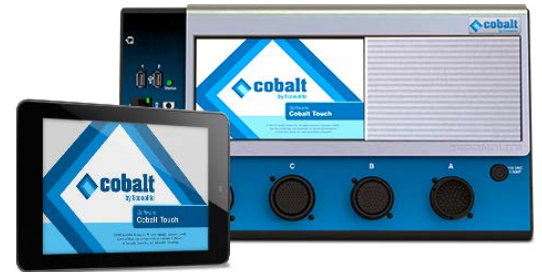
Pantalla Touch-Screen de 7" y plataforma más amigable e interactiva para programar un control de semáforos.
